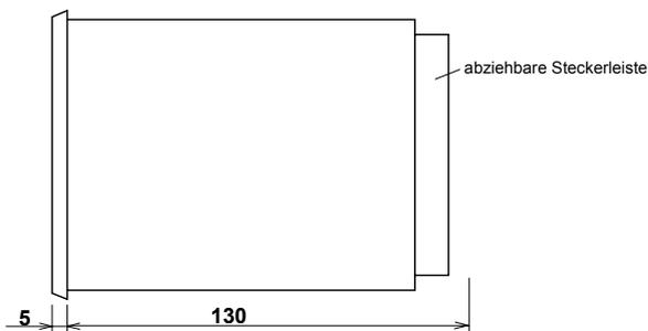
Sie müssen das Gehäuse des neuen Reglers unbedingt an Schutz Erde anschliessen (Klemme 3). Alle anderen Anschlüsse können Sie einfach auf die abziehbaren Steckerklemmen des neuen Reglers umklemmen:
