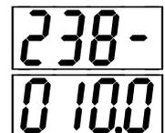
Wird eine Alarmbedingung erfüllt, für die eine Anzeige programmiert ist, so blinkt die obere Anzeige mit dem entsprechenden Symbol (siehe Alarmprogrammierung Seite 15).
